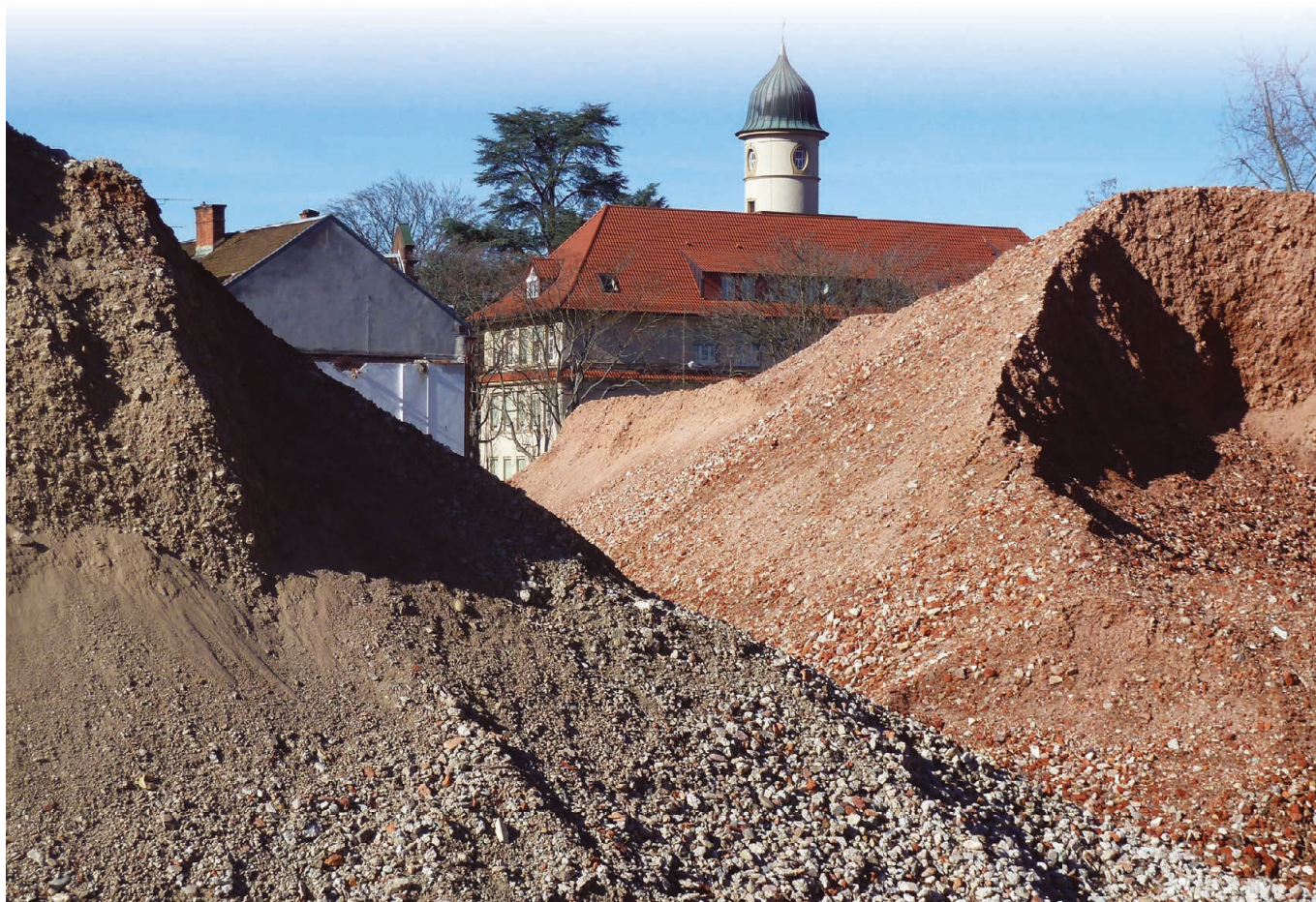
Abb. 1: Gesiebter Betonabfall (li) und gesiebter Ziegelabfall (re), der beim Abriss der Kronen-Brauerei in Offenburg anfiel
