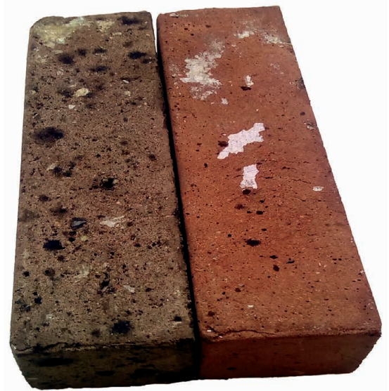
Abb. 2: Teststeine der Größe 4 x 4 x 16 cm Betonabfall (li), Ziegelabfall (re)
